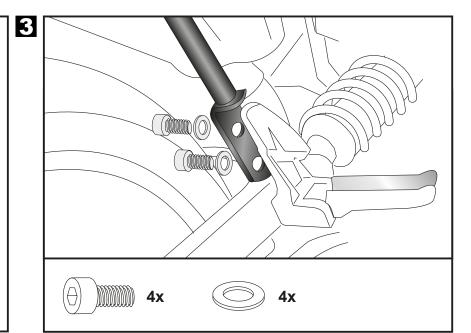
Befestigung der Abstützstreben links und rechts mitte:
