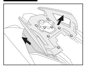
Die hinteren Blinker verbleiben in der Originalposition. Sitzbank entfernen. Haltegriff-Element entfernen. Schwarze Kunststoffverkleidungen links und rechts lösen.
