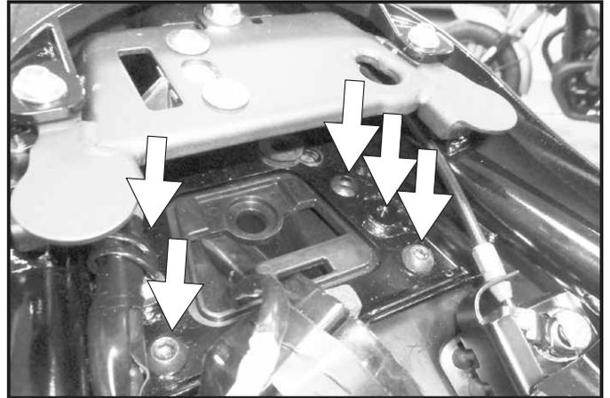
Nun die Blinker lösen und durch das Heck entnehmen, diese werden an den Blinkerhalter wie original befestigt.
