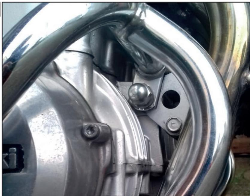
**Montage Motorschutzbügel unten rechts/links:**
