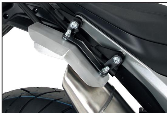
Bei langen Autobahnfahrten entsteht durch die Auspuffsituation ein enormer Hitzestau, der zum Schmelzen vom Topcasekunststoff oder anderen Gepäckstücken führen kann. Wir empfehlen daher unbedingt die Verwendung unseres optionalen Hitzeschutzblechs Art.Nr.: 42247569 00 91/42247602 00 91
