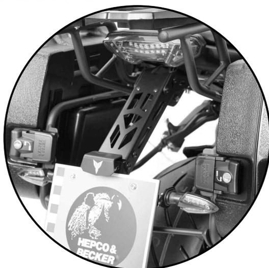
Der Kofferträger kann auch in Verbindung mit dem Yamaha Heckumbau lang montiert werden. Die kurze Version ist allerdings nicht möglich.
