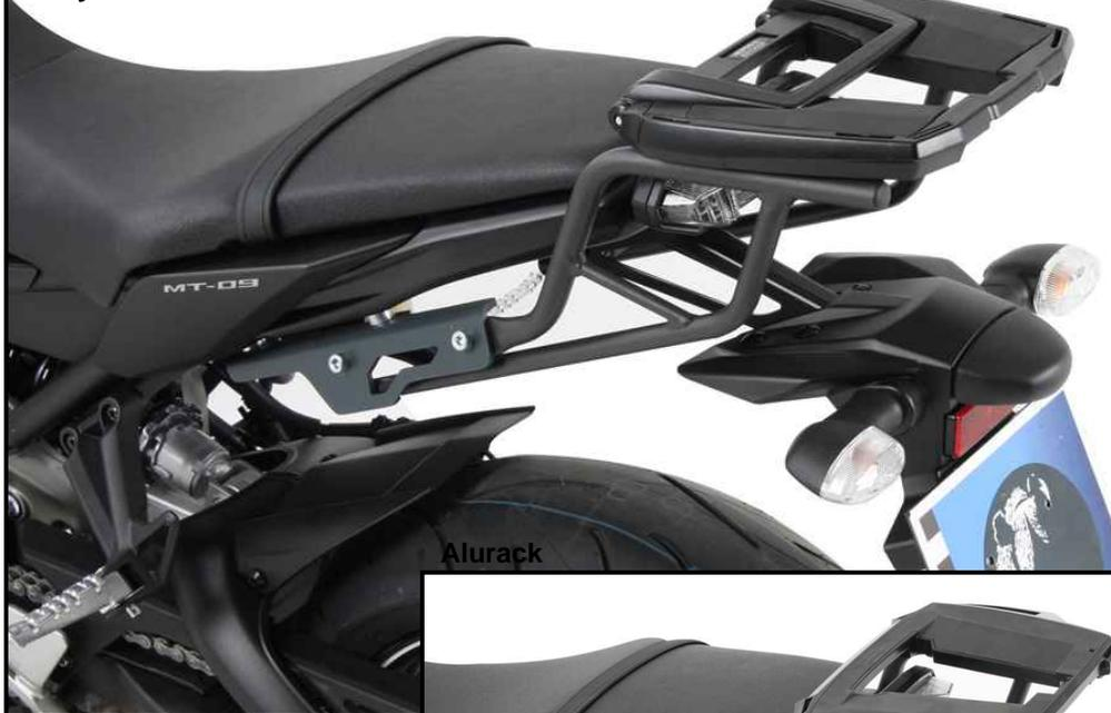
Auch in Verbindung mit dem Yamaha Heckumbau (kurz oder lang).
