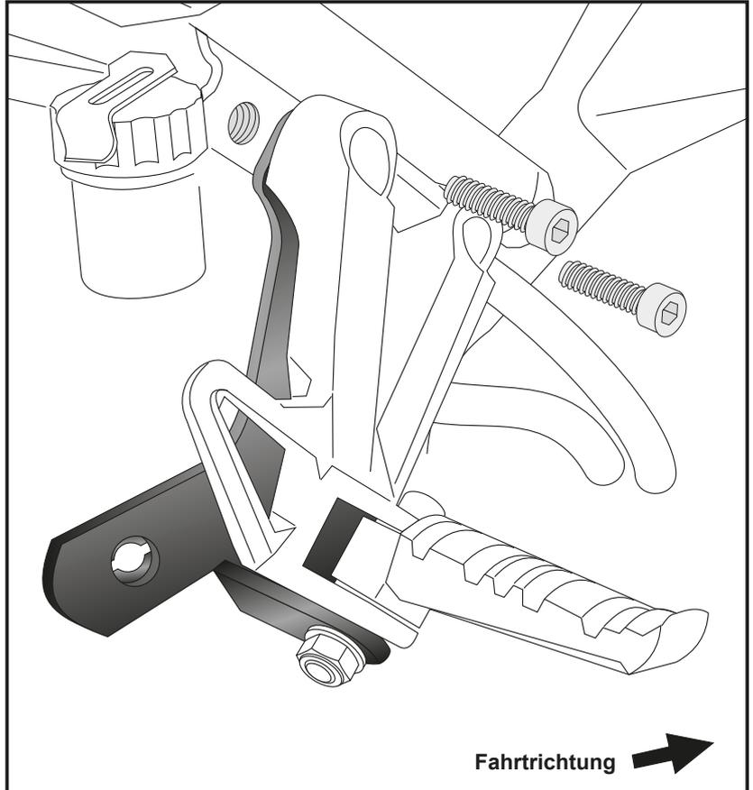
Montage der Lock it System-Schrauben:
