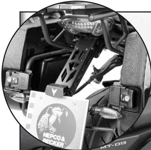
Der Kofferträger kann auch in Verbindung mit dem Yamaha Heckumbau lang montiert werden. Die kurze Version ist allerdings nicht möglich. Auch passend mit Helmschloss
