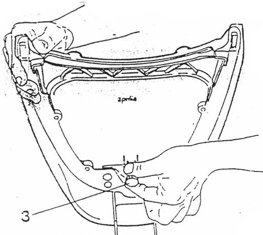
Die vier Gummibelagscheiben in die vier Löcher 4 der Deckplatte 2 einfügen und diese wieder auf den Kunststoffrahmen montieren. Danach die Rändelschrauben 3 wieder festziehen.
