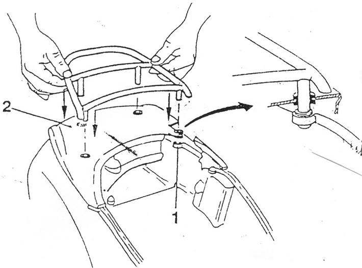
Den Gepäckträger derart auf die Deckplatte 2 aufsetzen, daß die 4 Öffnungen des Gepäckträgers mit den Öffnungen des Kunststoffrahmens 1 übereinstimmen; dabei müssen die Büchsen des Gepäckträgers gut eingeschmiert werden.
