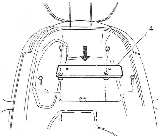
Die Halteplatte 4, wie in der Zeichnung angegeben, in die richtige Position bringen, die Originalschrauben entfernen und die Halteplatte mit den mitgelieferten Inbusschrauben M 6 x 40 und Karosserischeiben  $\phi 6,4$  x 20 montieren.
