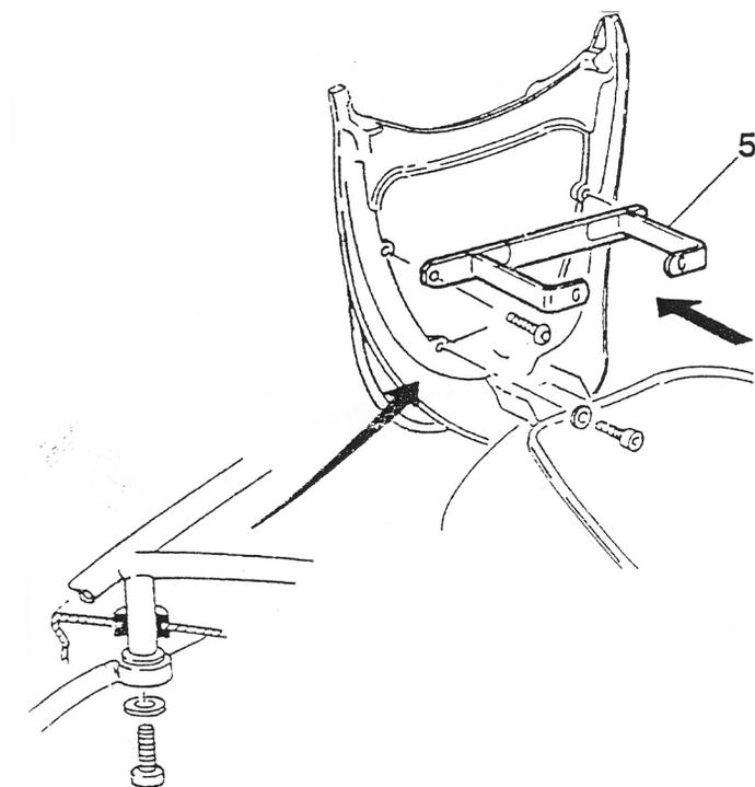
Die Halterung 5, wie in der Zeichnung erkennbar, an die beiden Haltepunkten des Kunststoffrahmens 1 anbringen und sie mit den Beilagscheiben und Inbusschrauben M 6 x 30 an die Gewindebüchsen des Gepäckträgers montieren; was den rückwärtigen Teil anbelangt, reicht ein Befestigen mit Hilfe der Beilagscheiben und Inbusschrauben M 6 x 25.
