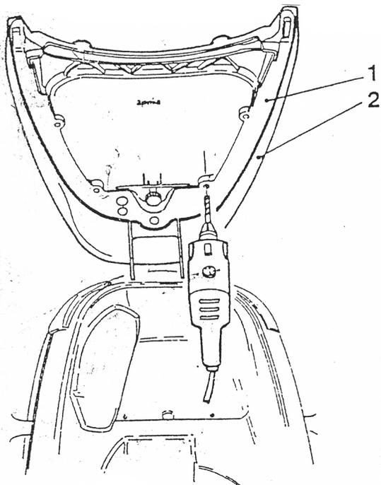
Die Öffnungen des inneren Kunststoffrahmens 1 mit Hilfe einer Bohrspitze mit dem Durchmesser 7, sowie die Deckplatte 2 mit derselben Bohrspitze bohren.
