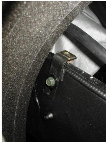
3. Befestigen Sie die Hinterradabdeckung mittels der Originalschrauben und der M5 Schraube und den Unterlegscheiben. Überprüfen Sie die Freigängigkeit des Rads und ziehen Sie die Schrauben alle fest.
