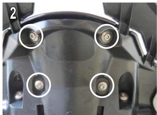
4. Befestigen Sie die Schnabelverlängerung an den hinteren Aufnahmen mittels den M5x45 Schrauben (7), die M5 U-Scheiben (5) kommen zwischen Schraubenkopf und Verlängerung, die 25mm Distanzen (3) zwischen Verlängerung und Motorrad. Ziehen Sie die Schrauben noch nicht fest. Abb. 3+5 / *Fit beak at rear positions using 2 M5x45 screws (7) with M5 washers (5) behind screw head and 25 mm long spacer (3) on top of beak.. Leave screws loose to allow fitting of front fixings. Fig. 3+5*
