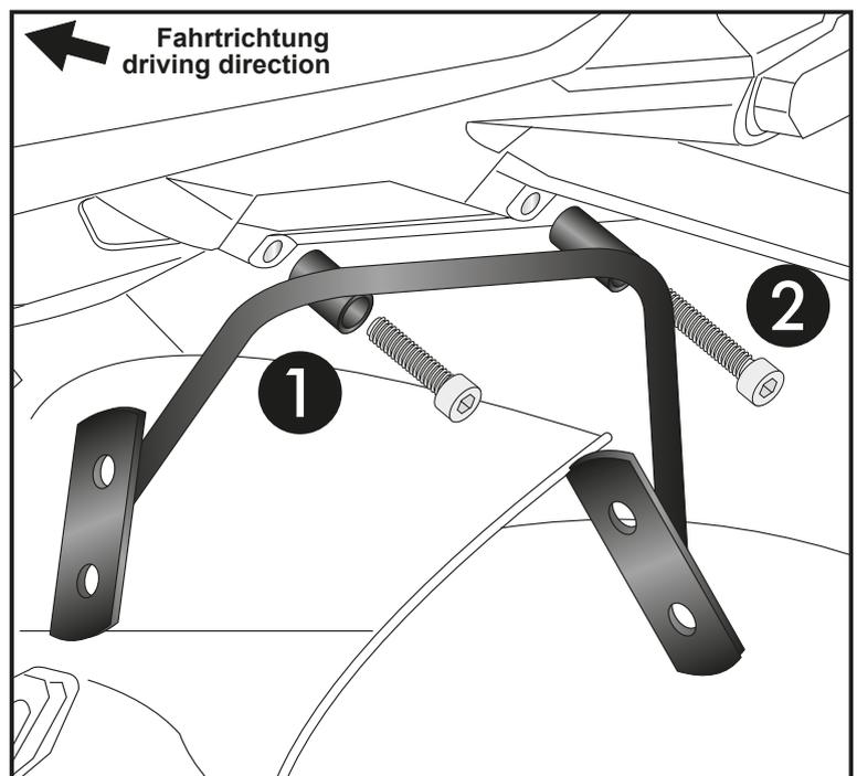
In Kombination mit dem Minirack werden vorne die Zylinderschrauben M6x65 und hinten die Zylinderschrauben M6x75 verwendet.
