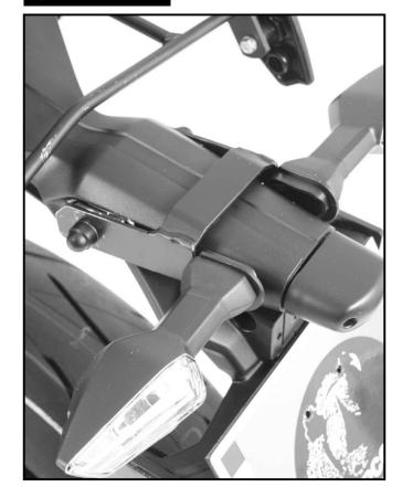
Die Abdeckkappen unter dem Heck entfernen, diese entfallen. Soziussitz sowie Fahrersitz entfernen. Die Blinker müssen verlegt werden.
