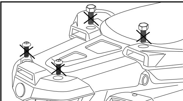
Die Original-Schrauben an der Gepäckauflage und am Haltegriff entfernen, diese entfallen.
